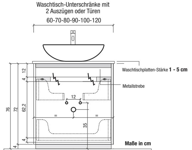
Die Holzstrebe zwischen den Metallwinkeln kann bei Bedarf abgeschnitten werden, falls störend für Wasser-Anschlüsse
