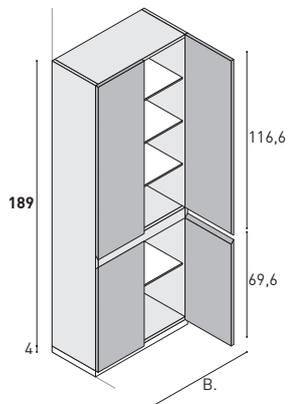
**Hochschrank mit 4 Türen, 4 Glas-Einlegeböden, 1 Holz-Einlegeboden (fix, durchgehend).**
