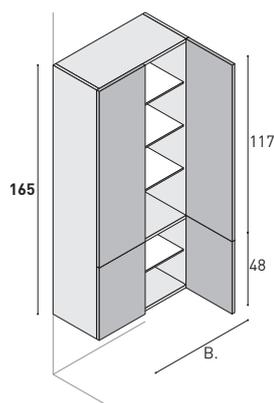
**Hochschrank mit 4 Türen, 4 Glas-Einlegeböden, 1 Holz-Einlegeboden (fix, durchgehend).**
