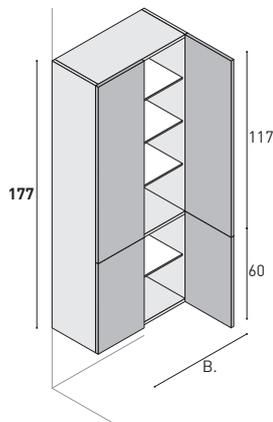
**Hochschrank mit 4 Türen, 4 Glas-Einlegeböden, 1 Holz-Einlegeboden (fix, durchgehend).**
