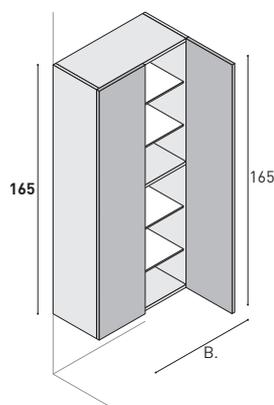
**Hochschrank mit 2 Türen, 4 Glas-Einlegeböden, 1 Holz-Einlegeboden (fix, durchgehend).**
