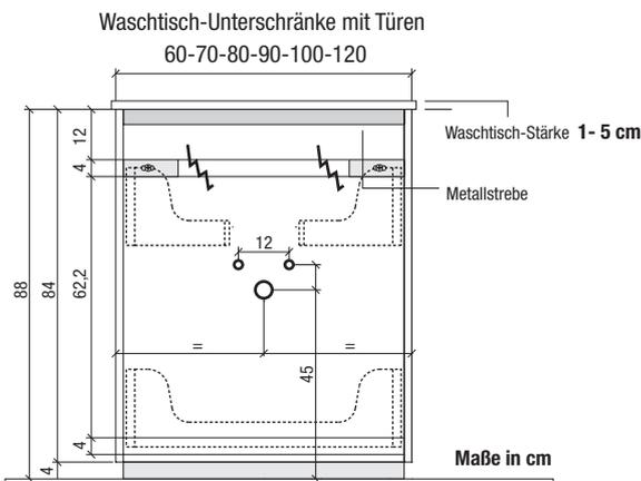
Die Holzstrebe zwischen den Metallwinkeln kann bei Bedarf abgeschnitten werden, falls störend für Wasser-Anschlüsse
