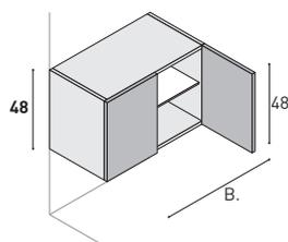
**Unterschrank mit 2 Türen, 1 Glas-Einlegeboden (fix, durchgehend).**
