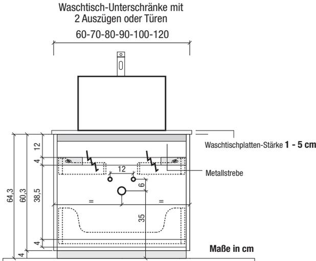
Die Holzstrebe zwischen den Metallwinkeln kann bei Bedarf abgeschnitten werden, falls störend für Wasser-Anschlüsse
