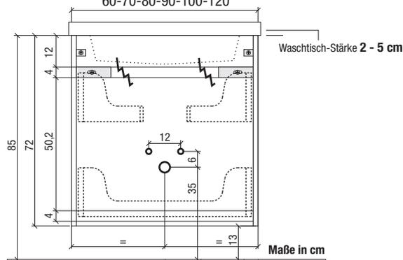
Die Holzstrebe zwischen den Metallwinkeln kann bei Bedarf abgeschnitten werden, falls störend für Wasser-Anschlüsse
