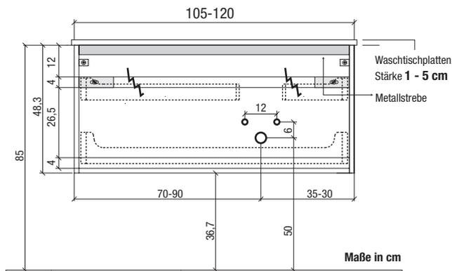
Die Holzstrebe zwischen den Metallwinkeln kann bei Bedarf abgeschnitten werden, falls störend für Wasser-Anschlüsse
